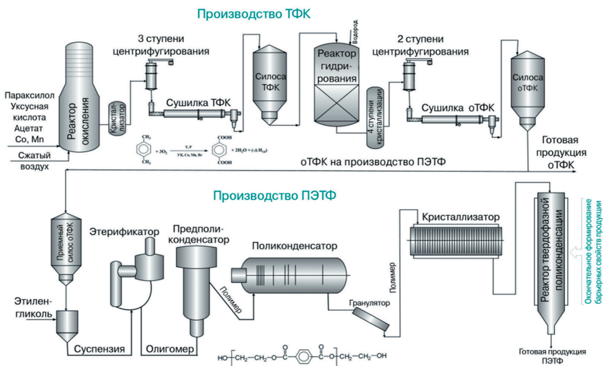
Рисунок 1. Принципиальная схема производства ТФК и ПЭТФ
